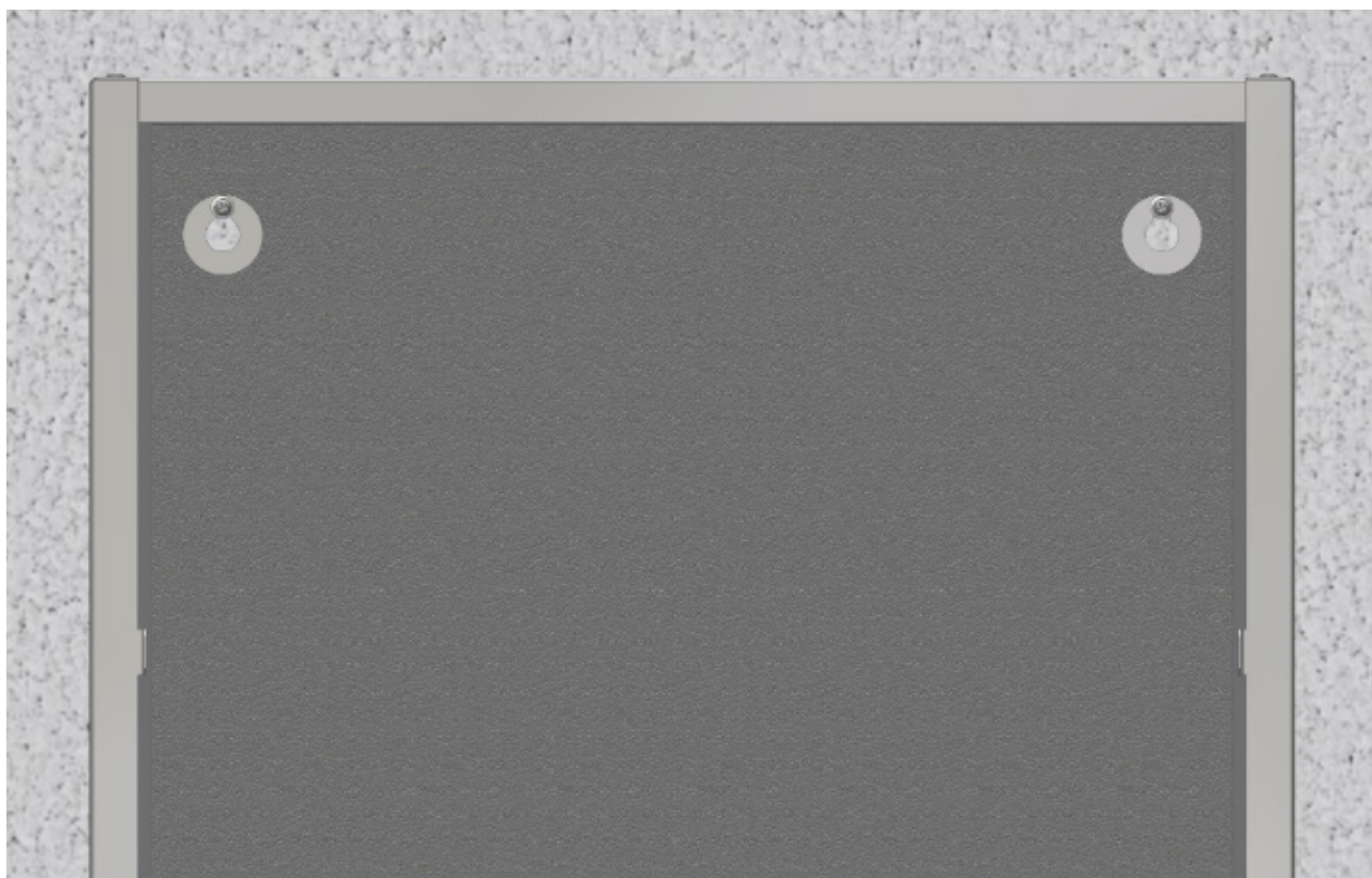
Přišroubování skříně pro nástěnnou montáž ke stěně
