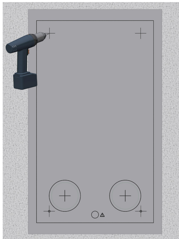
Vyvrtní označených otvorů
