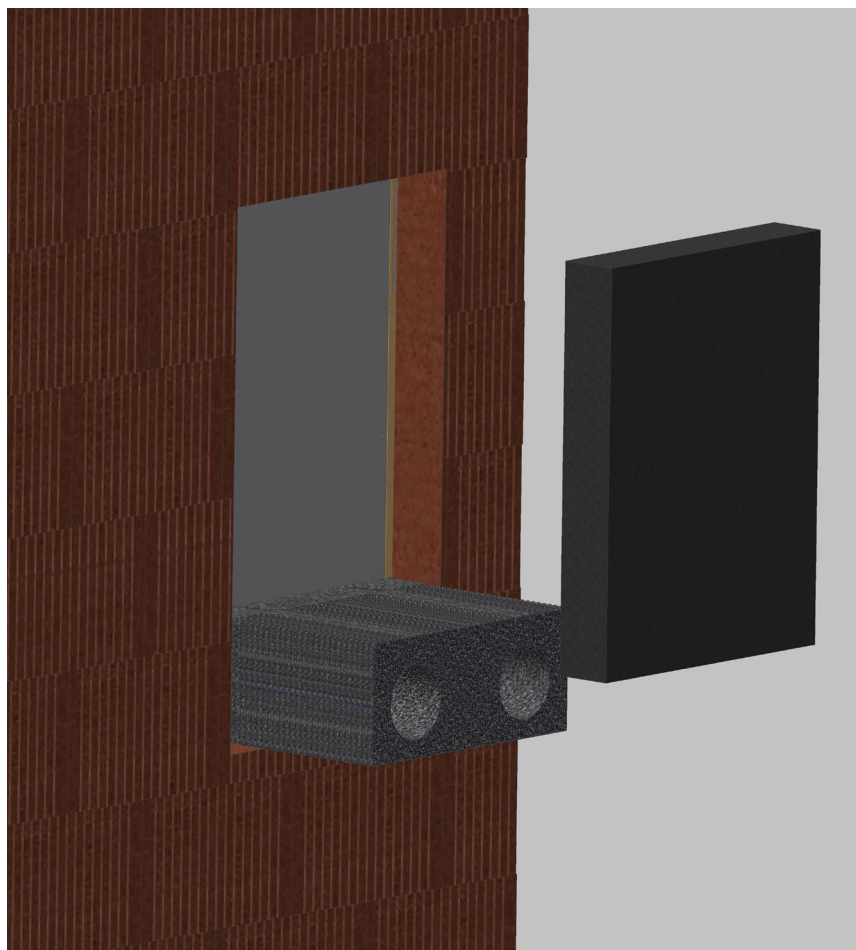
Nalepení vyrovnávací izolace pomocí lepicí pěny ETICS
