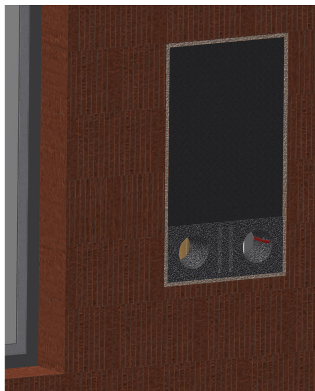
Stěnová průchodka v jedné rovině se zdí
