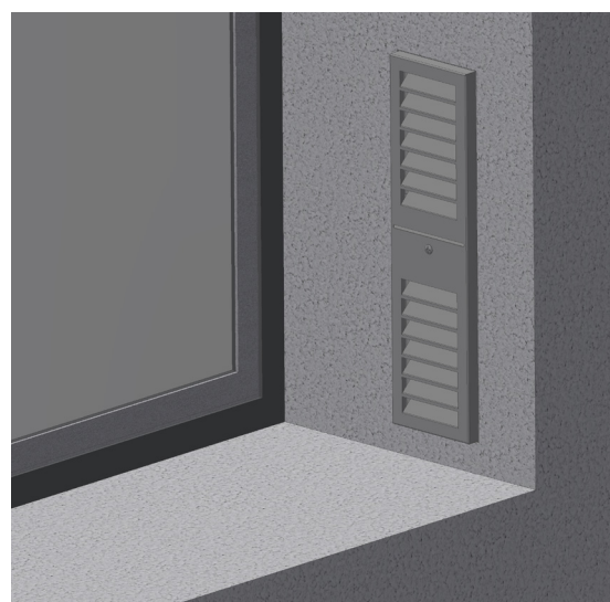
Umístění ochranné mřížky proti povětrnostním vlivům
