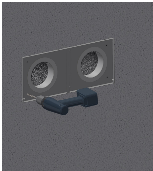
Předvrtání stěnové průchodky z EPP vrtákem o průměru 6 mm
